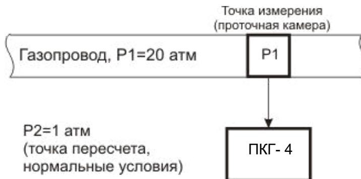
Рисунок 6.12 Пример использования пересчета объёмной доли кислорода от давления.
